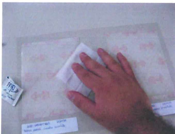
Figura 6 – Limpeza da transparência após fixação do adesivo
