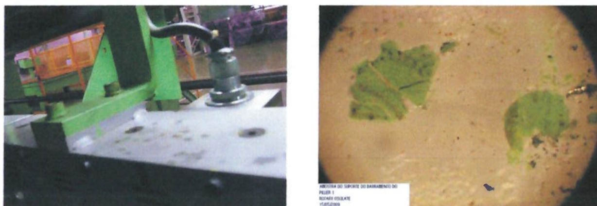
Figura 14 – Superfície do barramento das correias magnéticas e análise da composição química
