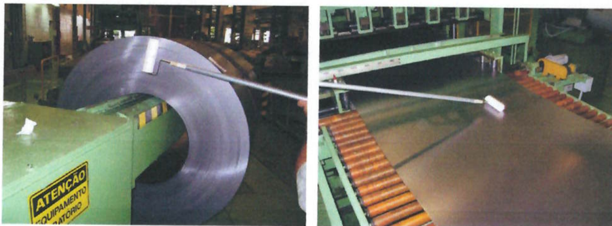
Figura 3 – Aplicação do rolo sobre a superfície da bobina
